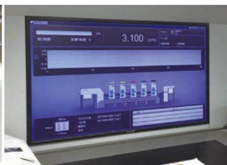
3台全てにインラインカメラを設置。ピンホールや網抜けといった不良に関してもカメラで完全キャッチ。ディスプレイには、カメラで撮影された刷本の濃度が数値やグラフで映し出され、濃度管理も一目瞭然。
