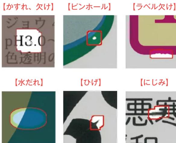
インライン検査では検出不可能なレベルのピンホール・欠け等の不良も瞬時に検出します。デジタルデータとの比較検査も高精度で行います。
